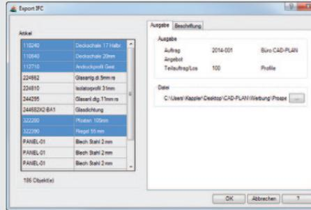
Es können auch Objekte von Revit an ATHENA übergeben und dann mit Profilen, Füllungen, Blechen etc. belegt werden. Diese lassen sich danach wieder zurück transportieren.
